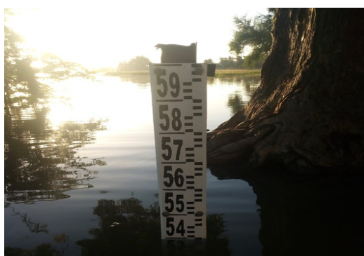
Photo 1 : Dispositif de mesure (limnigraphe) de la côte atteint par la Komadougou Yobé le 8 novembre 2020 avec une hauteur de 5,41m à la station de Bagara
